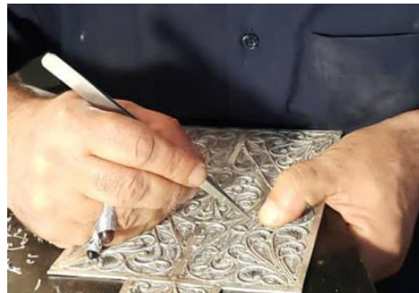
تصویر ۱. ساخت ملیله روی صفحه فلزی، کار آقای اصغر نژاد ملیله کار اردبیلی
