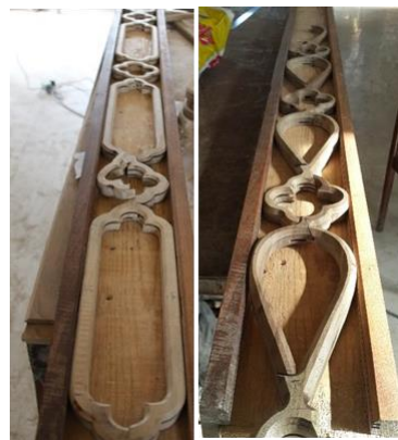
تصویر ۱۷- چیدن آلت ها در چهارچوب
