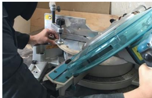
تصویر ۱۴- شیب زدن آلت ها با زاویه ۴۵ درجه
