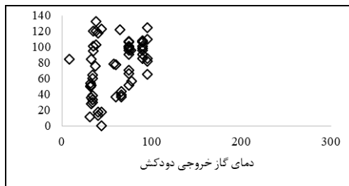
شکل ۴- برازش خط مرزی بین عامل هوای مازاد با دمای گاز خروجی دودکش
