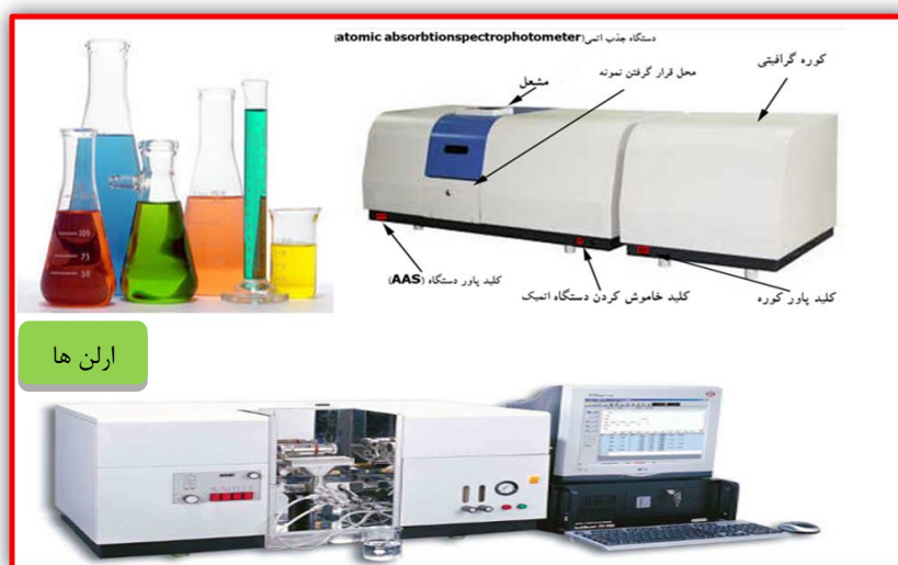
شکل ۲- دونه نمونه دستگاه اسپکتروفتومتر جذب اتمی (AAS) که جهت جذب میزان سرب مورد سنجش وارلن ها جهت محلول ها مأخذ: WWW.ulab.ir
