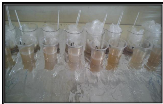
شکل ۶- هضم کردن نمونه های عضلانی به روش اسید- پپسین
