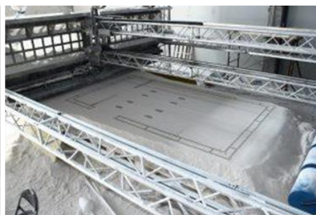
شکل ۲- چاپگر (D-Shape در سمت چپ) و شی چاپ شده - صخره مرجانی (در سمت راست) (D-Shape, 2018)
