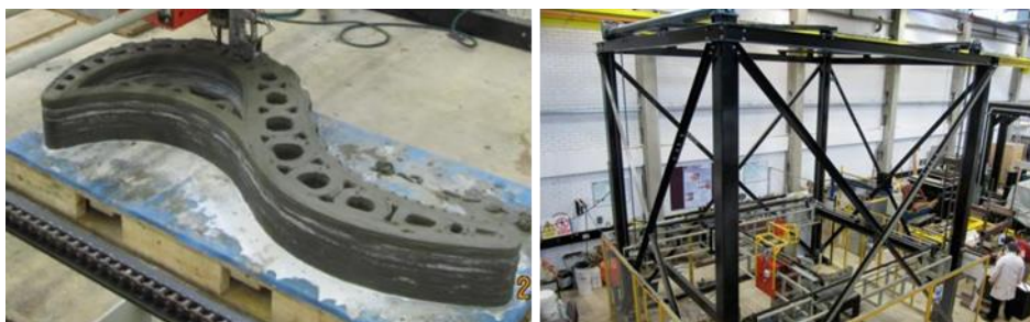
شکل ۳- سیستم چاپ بتن (در سمت چپ) و نیمکت چاپی (در سمت راست) (Lim, Buswell, Austin, Gibb, Thorpe, 2012)
