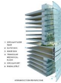
شکل ۴. دیوار دولایه برج شانگهای www.soorstudio.com
