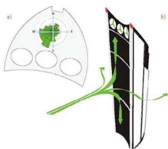
شکل ۴: مطالعه جهت‌گیری بر اساس جهت باد غالب. طرح نقشه سایت با نمودار وضع هوا و میزان وزش بادهای جهت‌دار (a) و تصویری از توزیع جریان هوا در اطراف برج (b)
