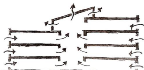
شکل ۱۷- تاثیر اختلاف دما و ارتفاع محل استقرار پنجره‌ها بر تهویه ساختمان
