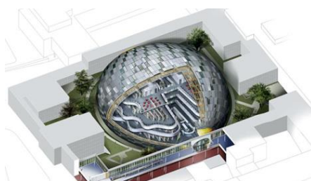
شکل ۳- دانشگاه ادبیات نورمن فاستر، نحوه سیرکولاسیون هوا، ورود هوای تمیز و خروج هوای آلوده (خانی زاد، ۱۳۹۲)
