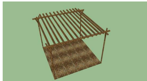
شکل ۵- قرار گرفتن تیرهای چوبی برای پوشش سقف
