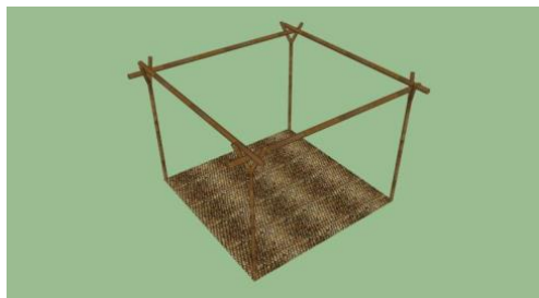
شکل ۴- اسکلت چوبی کاوار
