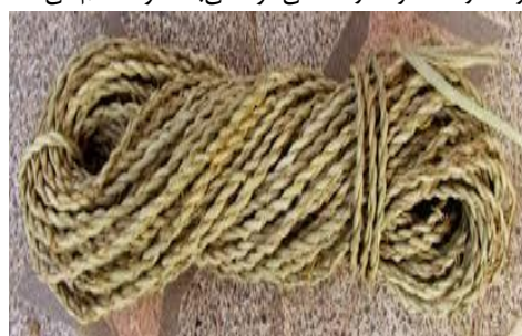
شکل ۷- چیلک، تهیه شده از برگ نخل یا داز (نخل ایرانی) برای بستن نقاط اتصال تیرهای کاوار یا بنش‌بندی
