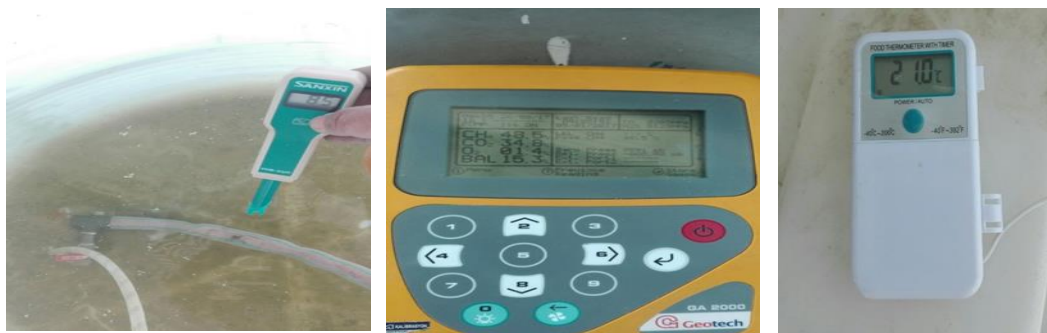
تصویر ۷: از راست ترمومتر دیجیتال، آنالیزور گاز، pH متر پرتابل
