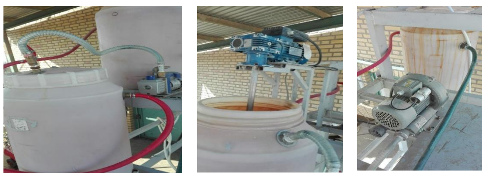
تصویر ۴- از راست نمایش مخزن استراحت و بلوئر استقرار داده شده در کنار آن، مخزن آزاد سازی و همزن، مخزن خلأ و پمپ خلأ متصل به آن
