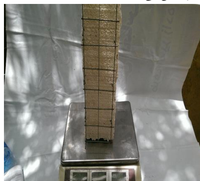
شکل ۱- ساخت نمونه تک سلولی از سازه سه بعدی 3D پانل با ابعاد ۱۰*۱۵*۳۰ سانتیمتر
