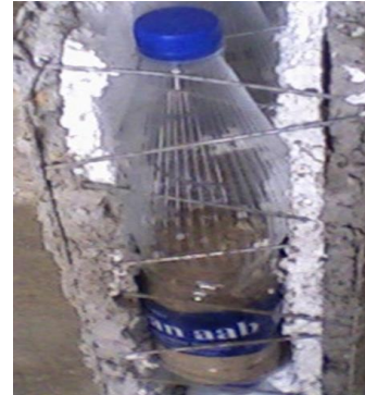
شکل ۳- ساخت نمونه تک سلولی از سازه بطری پانل با بطری نیمه پر شده از ماسه خشک با ابعاد ۱۵*۳۰*۱۰ سانتیمتر
