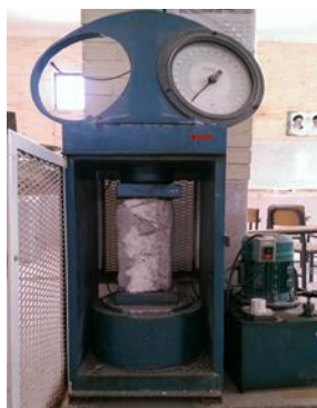
شکل ۱- ساخت نمونه تک سلولی از سازه سه بعدی 3D پانل با ابعاد ۱۰*۱۵*۳۰ سانتیمتر
