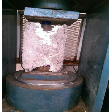
شکل ۳- ساخت نمونه تک سلولی از سازه بطری پانل با بطری نیمه پر شده از ماسه خشک با ابعاد ۱۵*۳۰*۱۰ سانتیمتر
