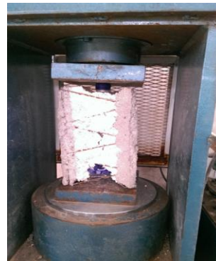
شکل ۲- ساخت نمونه تک سلولی از سازه بطری پانل با بطری خالی با ابعاد ۱۵*۳۰*۱۰ سانتیمتر
