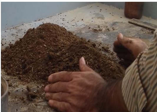
شکل ۲: خاک با نفت خام آغشته گردید تا برای آزمایشات مورد بررسی قرار بگیرد.
