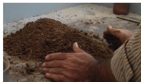
شکل ۴: خاک آلوده به نفت که با نفت خام آغشته گردید تا برای آزمایشات مورد بررسی قرار بگیرد
