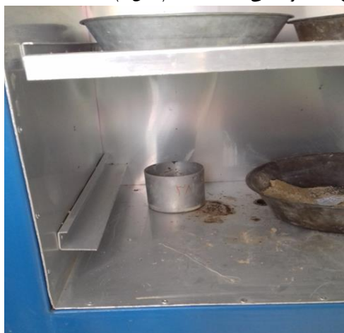
شکل ۶: دستگاه آون برای حفظ حرارت طبیعی و رطوبت خاک
