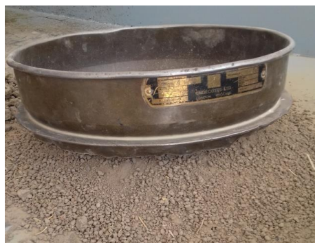
شکل ۳: الک ۳/۴ برای جداسازی خاک ریز و درشت و استفاده از خاک ریز برای آزمایش
