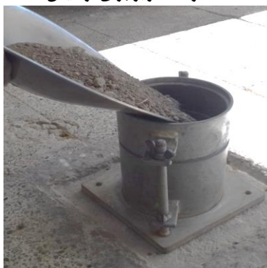
شکل ۵: ریختن خاک در قالب که مقدار خاک مورد نیاز گردآوری شده در قالب مخصوص خود برای انجام آزمایشات مختلف ریخته شد.
