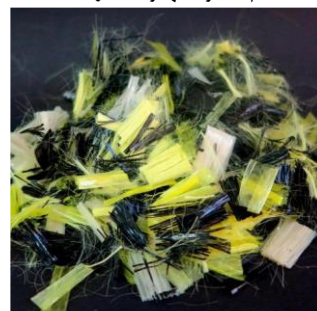
تصویر ۵: الیاف آسفالتی، برای آسفالت نیمه گرم دمای مخلوط ۱۰۰ درجه سانتی گراد و بالاتر (WMA Blend for WARM MIX ASPHALT)، مأخذ: www.sirjannano.com
