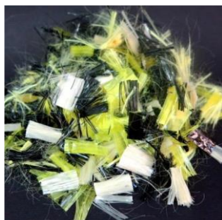
تصویر ۶: الیاف آسفالتی، برای آسفالت گرم دمای مخلوط ۲۰۰ - ۱۲۰ درجه سانتی گراد (HMA Blend for HOT MIX ASPHALT)، مأخذ: www.sirjannano.com
