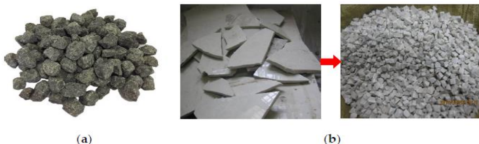
تصویر ۲: سنگدانه مورد استفاده در آسفالت: (الف) سنگدانه بازالت. (ب) سنگدانه های ضایعات سرمایی خرد شده. مأخذ: Huang, et al., 2020, p.3
