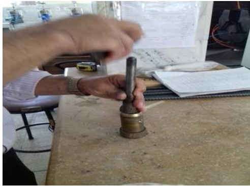
شکل ۱: کوبیدن خاک در قالب نفوذ پذیری
