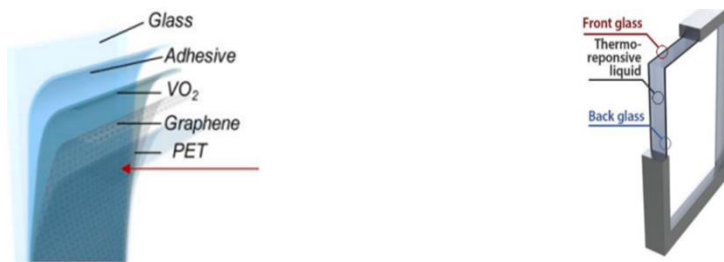
تصویر ۳: ساختار پنجره هوشمند با قابلیت ذخیره‌سازی انرژی بالا (Wu, S., et al, 2023)
