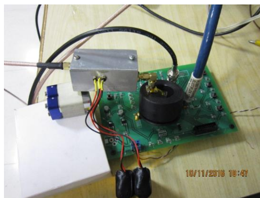
شکل ۹: نحوه‌ی قرارگیری پروب نسبت به میکروکنترلر
