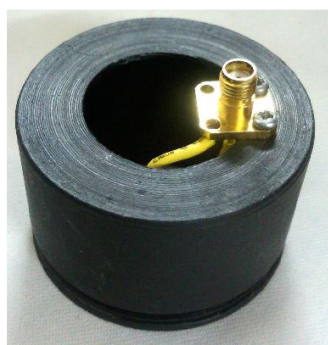
شکل ۵: نمایی از آنتن طراحی شده
