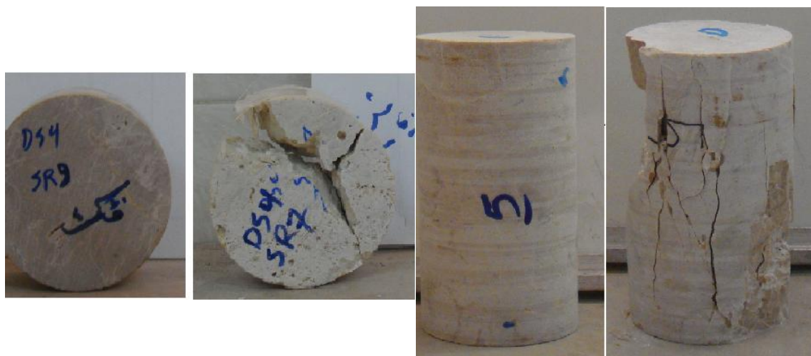
شکل ۱۵- نمایی از نمونه تحت آزمایش تک محوره قبل و بعد از شکست شکل ۱۶- نمایی از نمونه تحت برزیلین قبل و بعد از شکست
