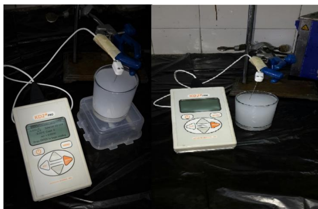
شکل (۱): نمایی از دستگاه اندازه گیری ضریب انتقال حرارت هدایتی بکار رفته در آزمایش
