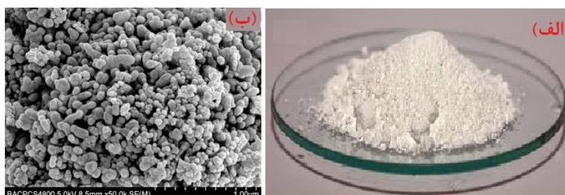
شکل (۲): نانوذرات دی اکسید تیتانیوم (TiO 2 )، (الف) شکل ظاهری، (ب) تصویر SEM.
