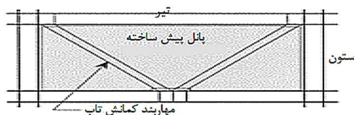
شکل ۱- مهاربند کمانش‌تاب قرار گرفته بین پانل‌های بتنی پیش‌ساخته.
