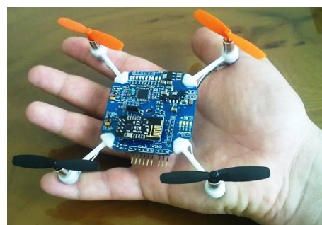
شکل ۱ - ربات پرنده چهار ملخه طراحی و ساخته شده
