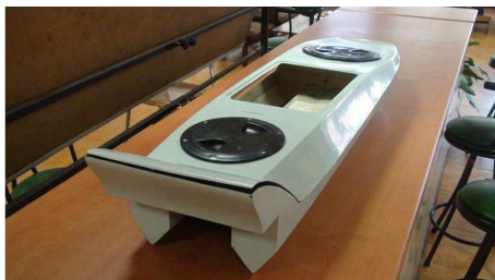
شکل ۲۴: مدل شناور تولید شده در کارگاه کامپوزیت
