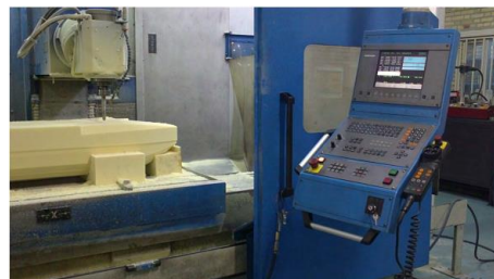
شکل ۲۳: مدل شناور در حال استخراج از دستگاه CNC
