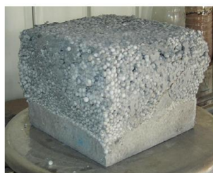
شکل ۱- بتن سبک مورد استفاده در سیستم JK
