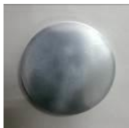
شکل ۵: سطح قطعه کار بعد از عملیات فاز یک با تغییر دادن متغیرهای سرعت دورانی، نیروی وارد بر سطح و زمان لپ کاری
