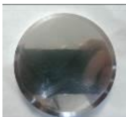
شکل ۷: سطح قطعه کار بعد از عملیات فاز سه با تغییر دادن متغیرهای سرعت دورانی، نیروی وارد بر سطح و زمان لپن کاری
