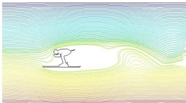
شکل ۶ توابع جریان در اطراف ورزشکار در سرعت 10 m/s
