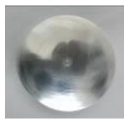
شکل ۸: سطح قطعه کار بعد از عملیات فاز دو با تغییر دادن متغیرهای نیروی وارد بر سطح و زمان لپن کاری
