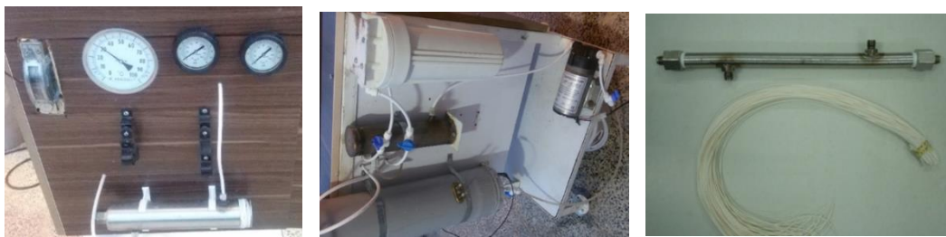
شکل (۱۰): ماژول غشایی و سیستم تماس دهنده غشایی
