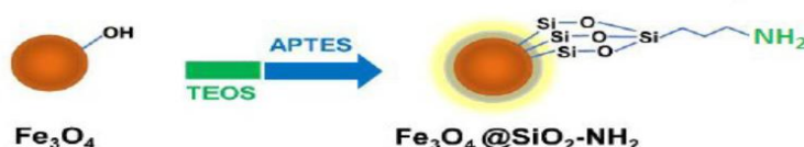
شکل (۱): مسیر سنتز \text{Fe}_3\text{O}_4@\text{SiO}_2 آمین دار شده
