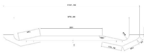
شکل ۲- نمای جانبی اکسل جلو خودرو پژو ۴۰۵
