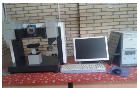
شکل (۳): نمایی از دستگاه اندازه‌گیری زاویه تماس بکار رفته در آزمایش
