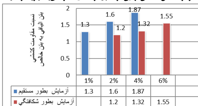
نمودار ۹: نسبت مقاومت کششی بتن الیافی به بتن خالص به دو روش آزمایش [۲۷] و [نگارنده]
