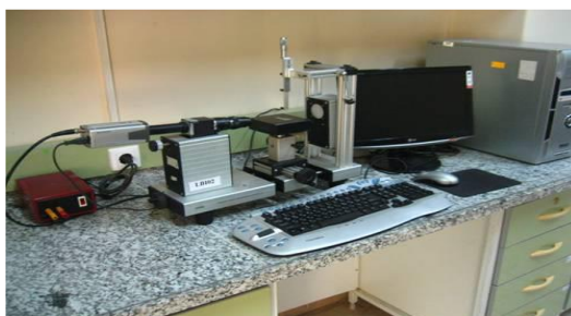
شکل (۱): نمای از دستگاه اندازه گیری زاویه تماس بکار رفته در آزمایش
