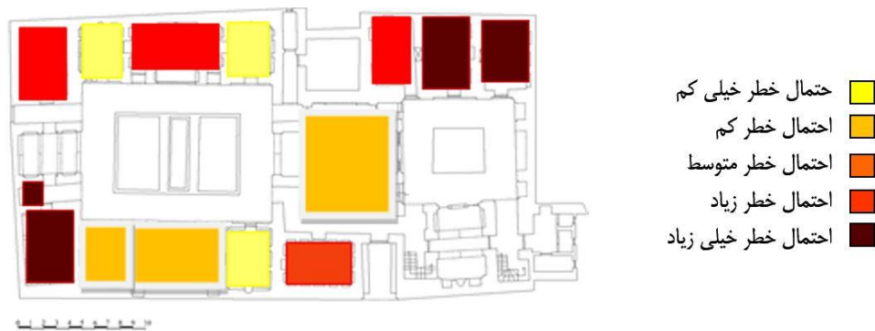
نقشه ۷ - مشخص کردن دفاتر پر خطر بر اساس احتمال خطر آتش سوزی الکتریکی
