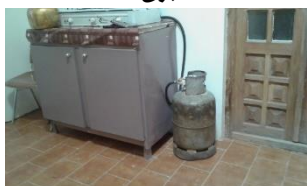
تصویر ۲۳- قرار گیری اجاق گاز بر روی کمد ناپایدار
