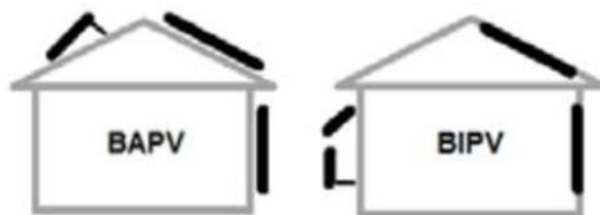
شکل ۱. تفاوت نحوه استقرار پنل ها در سیستم های BIPV و BAPV در پوسته ساختمان (غفوریان و احمدنژاد، ۱۴۰۴)
