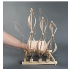
شکل ۲- مقیاس مدل نمونه اولیه غرفه با سیستم سازه خمشی فعال (مأخذ: ورکشاپ 3B Option Studio - پارامتری فضا و سیستم های مواد)
