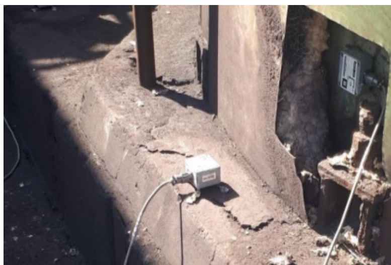
شکل ۳- سنسورهای شتاب‌سنج کابلی (مأخذ: شرکت سپاس، ۱۴۰۱)
