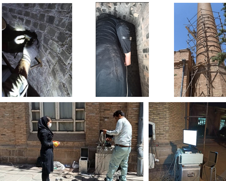
شکل ۲- مراحل انجام تست مودال عملیاتی (مأخذ: نگارنده، ۱۴۰۱)
