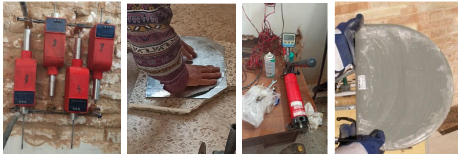
شکل ۵- ابزارهای انجام تست جک مسطح دوتایی (مأخذ: نگارنده، ۱۴۰۱)
