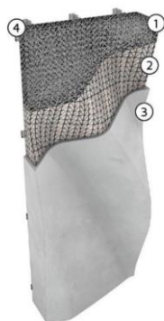
شکل ۳- دیاگرام سازه‌ای C-Fab (Platt Boy, Branch Technology, 2020)
