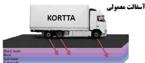
تصویر ۸: آسفالت معمولی، ورود نیروها به درون لایه آسفالتی و لایه های زیرین = ایجاد تنش و ترک خوردگی، مأخذ: www.sirjannano.com
