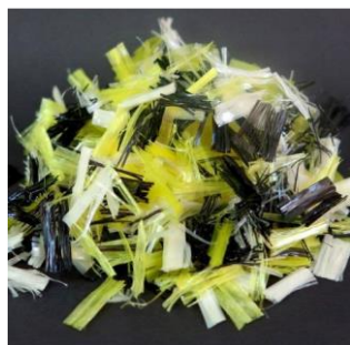
تصویر ۷: الیاف آسفالتی، برای آسفالت لکه گیری کلیه دماها (PAT Blend for HOT/COLD PATCH)، مأخذ: www.sirjannano.com
