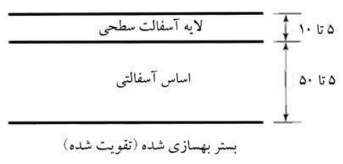
تصویر ۲: مقطع عرضی روسازی آسفالتی تمام عمق (ابعاد به سانتی متر است، مأخذ: Huang, 2003)
