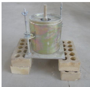
شکل (۱۱): هوادهی و خشک کردن نمونه
