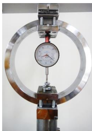
شکل (۸): گیج نیروی دستگاه سی بی آر
