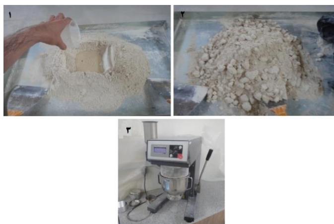
شکل (۵): مراحل مخلوط کردن خاک با آب
