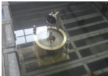
شکل (۱۰): کنترل تورم نمونه
