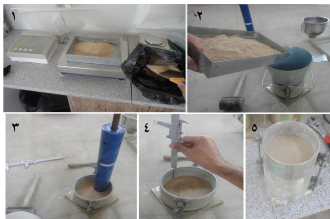
شکل (۷): مراحل متراکم نمودن نمونه
