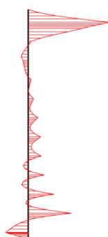
شکل ۱۲. لنگر خمشی جداره گودبرداری پس از اتمام نیلینگ
