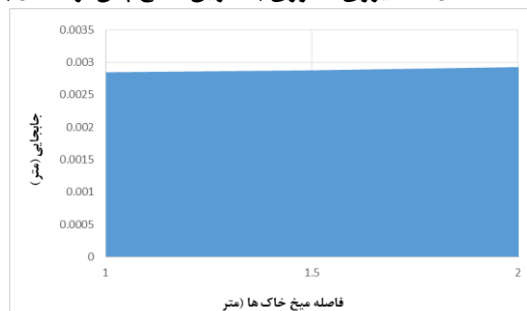
نمودار ۴. نمودار تغییرات جابجایی دیواره گودبرداری نسبت به فاصله میخ خاک ها
