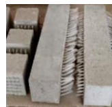
مرحله سوم: بعد از اتمام کار و خشک شدن کامل بتن از قالب جدا می شود.
