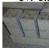
مرحله چهارم: اضافات فیبر نوری بریده میشود و بلوک های بتنی آماده هستند.
